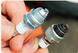
(左:新品 右:劣化品)
